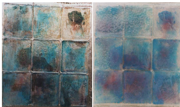
Document n°36 : Panneau filtrant réalisé avec la synolite 0328 - A – 1 (100 x 100 cm, épaisseur de 5 à 10 mm) vue de gauche : contre jour ; vue de droite : lumière frontale
