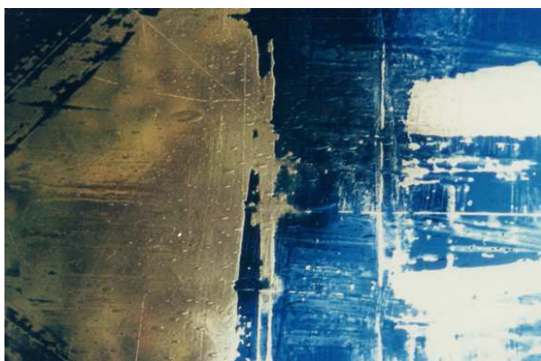
Document n°20 : Gravure à l'acide fluorhydrique d'un verre bleu plaqué jaune et blanc
