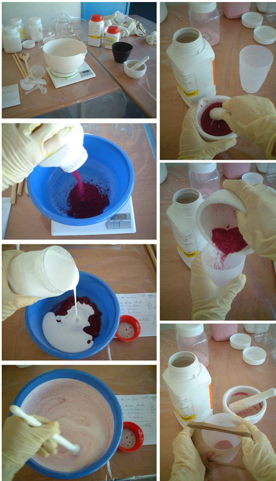
Document n°44 : association du pigment et de la résine par mélange pour une technique d'application (à gauche), écrasement manuel du pigment pour une technique de dispersion (à droite)
