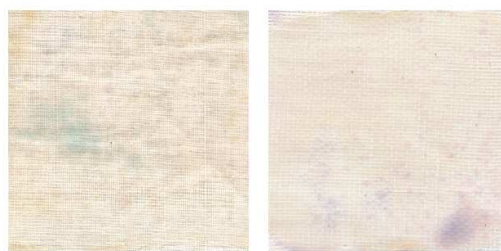
Document n°41 : échantillons scannés. Rhodopas A 13P (à gauche), Vinyl BT (à droite)
