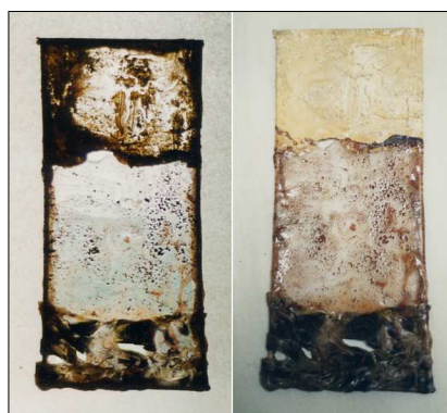
Document n°34 : Panneau filtrant réalisé avec Rhodopas A013P (100 x 54 cm, épaisseur de 1 à 3 mm) vue de gauche : contre jour vue de droite : lumière frontale
